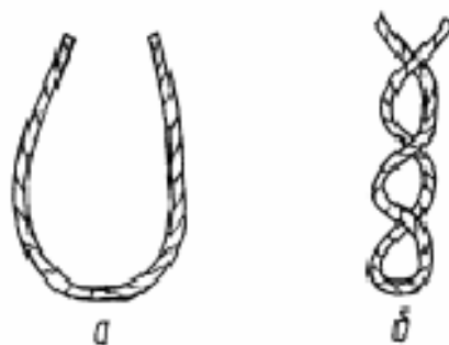
Рисунок 2.5 – Определение равновесности нитей при крутке а – уравновешенная нить, б – неуравновешенная нить
